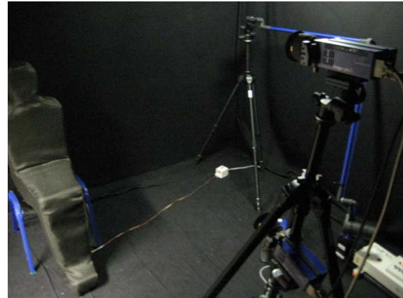
Abb. 2: Anordnung von Messpuppe, Kameras und Laserlichtschnitt
