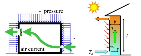
(c) Mechanical ventilation (d) Cavity ventilation
