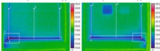
(c) non-defect section(lower) (d) defect section(lower)
