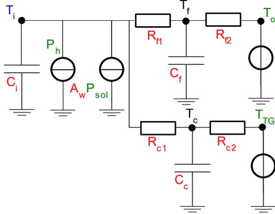
Figure 9: Model  $T_i T_f T_c A_w$
