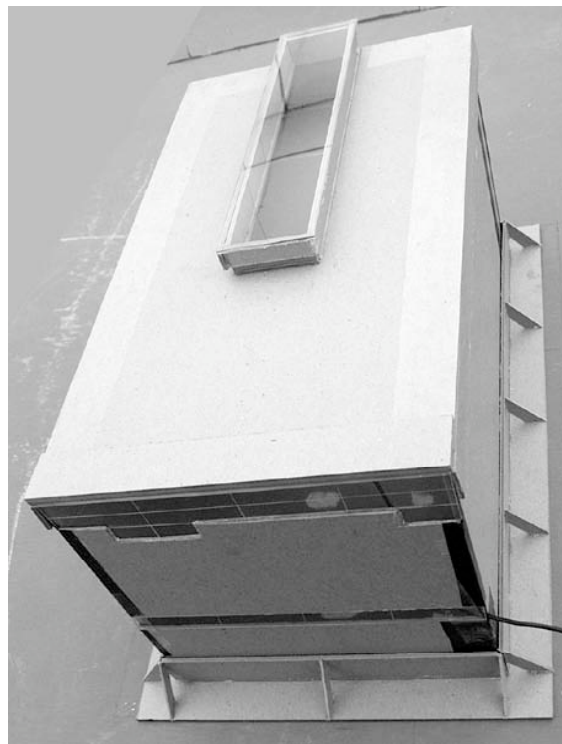
Figure 10 : Maquette d'un atelier typique du CTBO montrant une proposition de puits de lumière en toiture ainsi qu'une configuration de fenêtres en façade.
