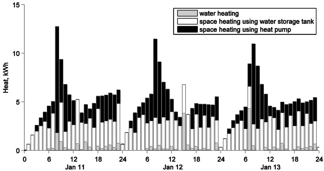
**Figure 3: Heating load of solar combisystem from Jan. 11 to Jan. 13**
