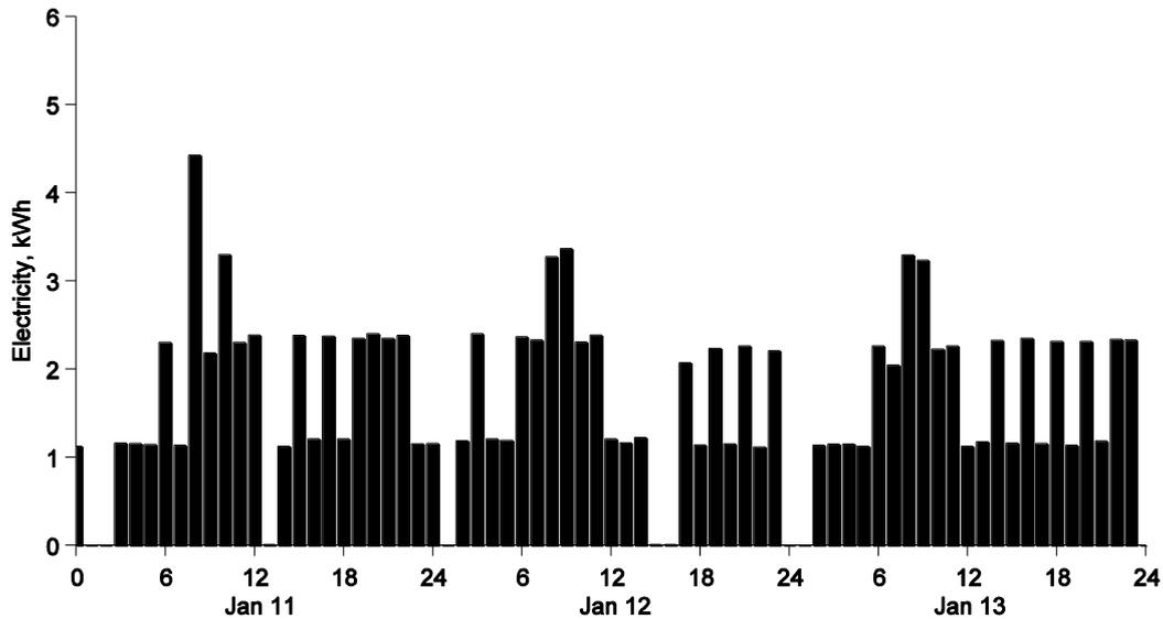
**Figure 4: Electricity consumption of solar combisystem from Jan. 11 to Jan. 13**
